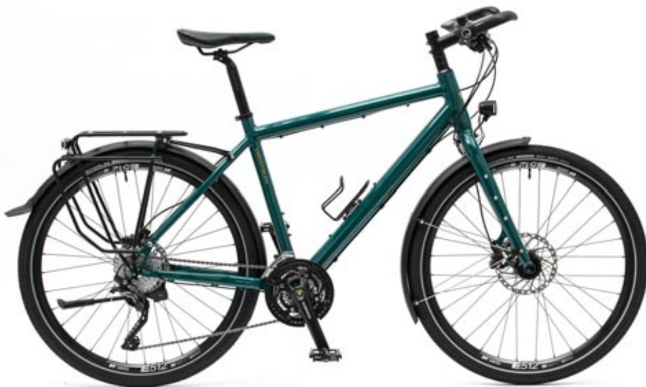
Abbildung: Rahmen R900 – Farbe: RAL 6033 – Größe »L« – Reifenformat: 50-584 mm – Gewicht: 14,9 kg Hinweis: Das abgebildete Beispiel für ein »R2« beinhaltet Wahloptionen
