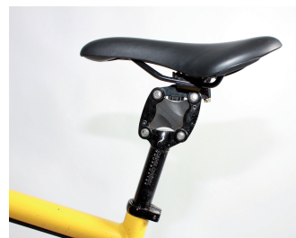
Geniales Komfort-Teil: Die Cane Creek ST-Federstütze bewirkt eine starke Stoßdämpfung.
