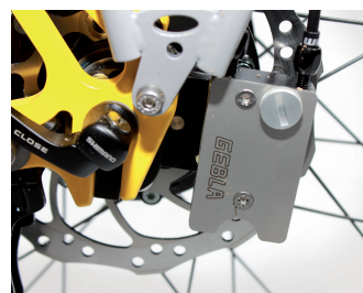
Genialer Schaltadapter: Die Rohbox von Gebla macht die Rohloff-Nabe mit Sram-Hebeln schaltbar.
